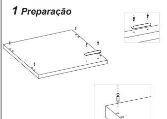
Parafuse a chapa trava N e fixe com os parafusos auto atarraxante 4X14I
