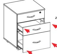
2.3 Encaixe as gavetas separadamente para finalizar a montagem do Arquivo
