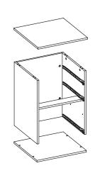
**2.2** Posicione o tampo e a base e fixe utilizando uma chave Philips ou Allen para a base
